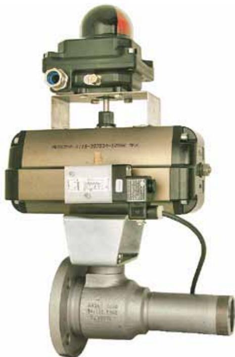
Быстрозакрываемый полнопроходной шаровой клапан PN40, исполнение «FireSafe» (BS 6755-2), антистатическое, с аттестатом 3.1.B EN 10 204
