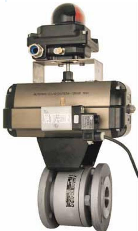
Быстрозакрываемый полнопроходной шаровой клапан PN40, исполнение «FireSafe» (BS 6755-2), антистатическое, с аттестатом 3.1.B EN 10 204
